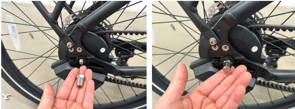
Figure 14 - Installer l'écrou d'axe de roue
