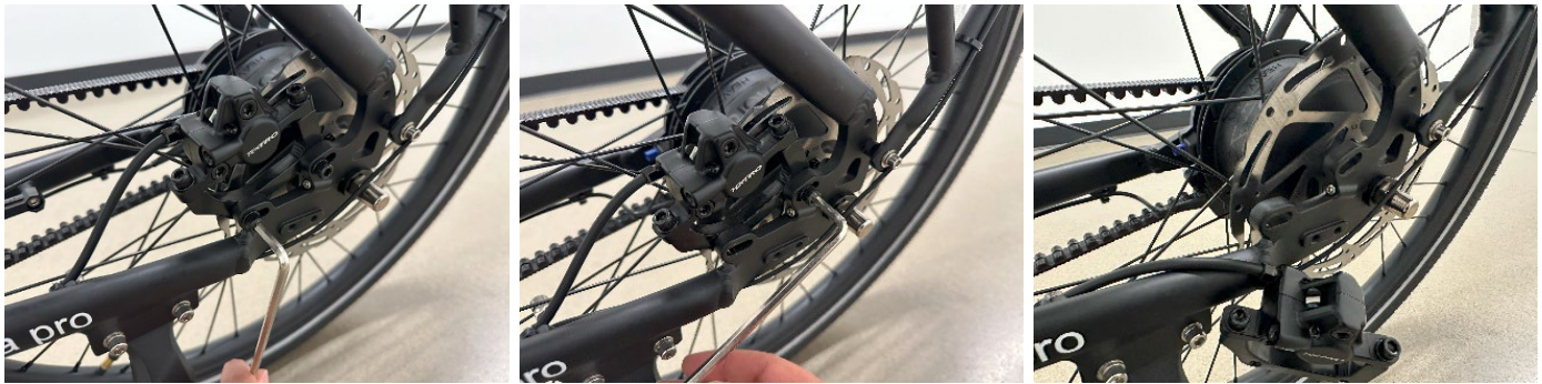
Figure 1- Enlever l'étrier de frein avec la clé Allen 5mm
