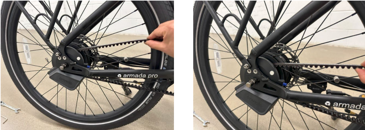
Figure 15 - La courroie se tend à mesure que l'on serre la vis de tension de courroie
