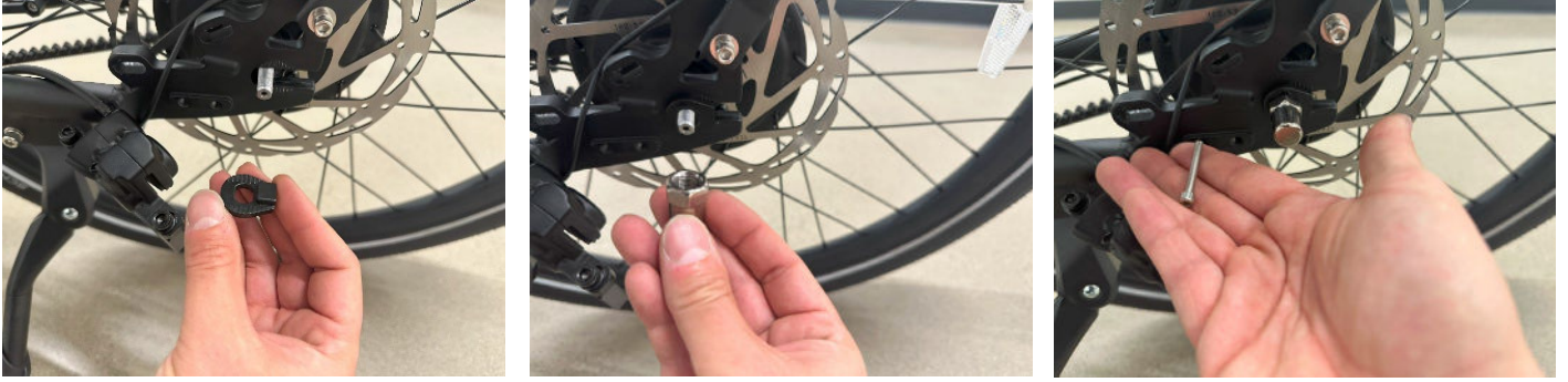
Figure 19 - Installer la visserie du côté gauche
