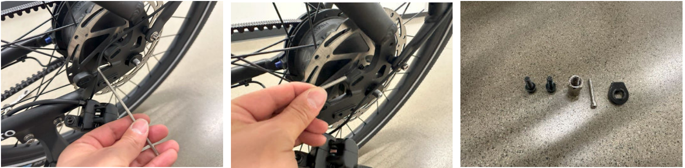
Figure 3 - Enlever la vis de tension de la courroie côté gauche
