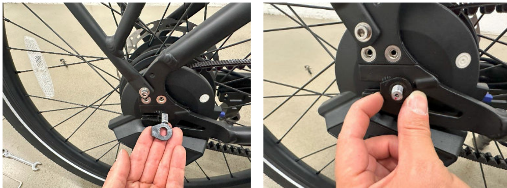
Figure 13 - Installer la rondelle à ergot
