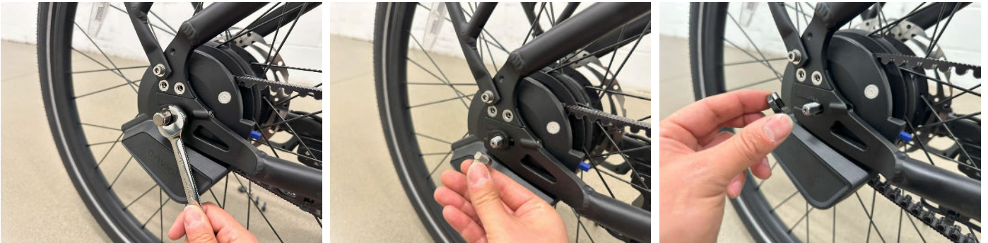
Figure 5 - Enlever l'écrou d'axe côté droite
