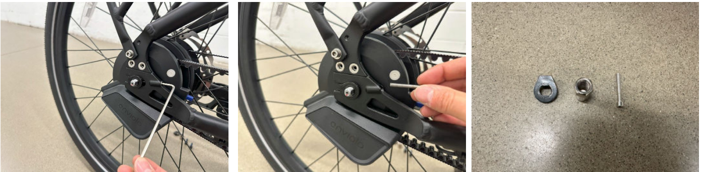
Figure 6 - Enlever la vis de tension de la courroie côté droite
