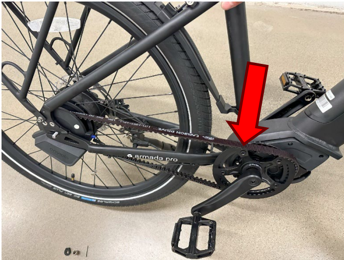
Figure 9 - Dérailler la courroie au niveau du plateau avant.
