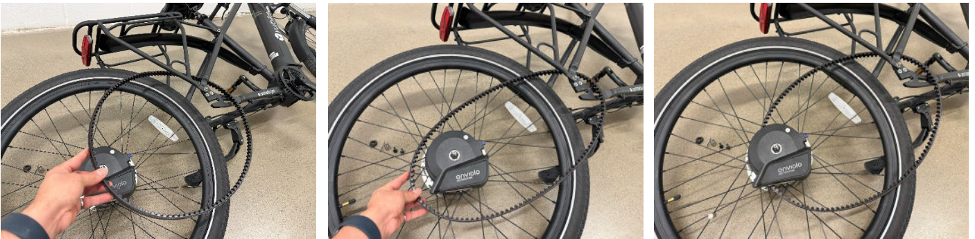
Figure 11 - Installer la courroie sur le pignon
