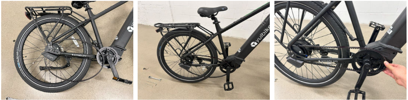
Figure 12 - Installer la courroie sur le plateau
