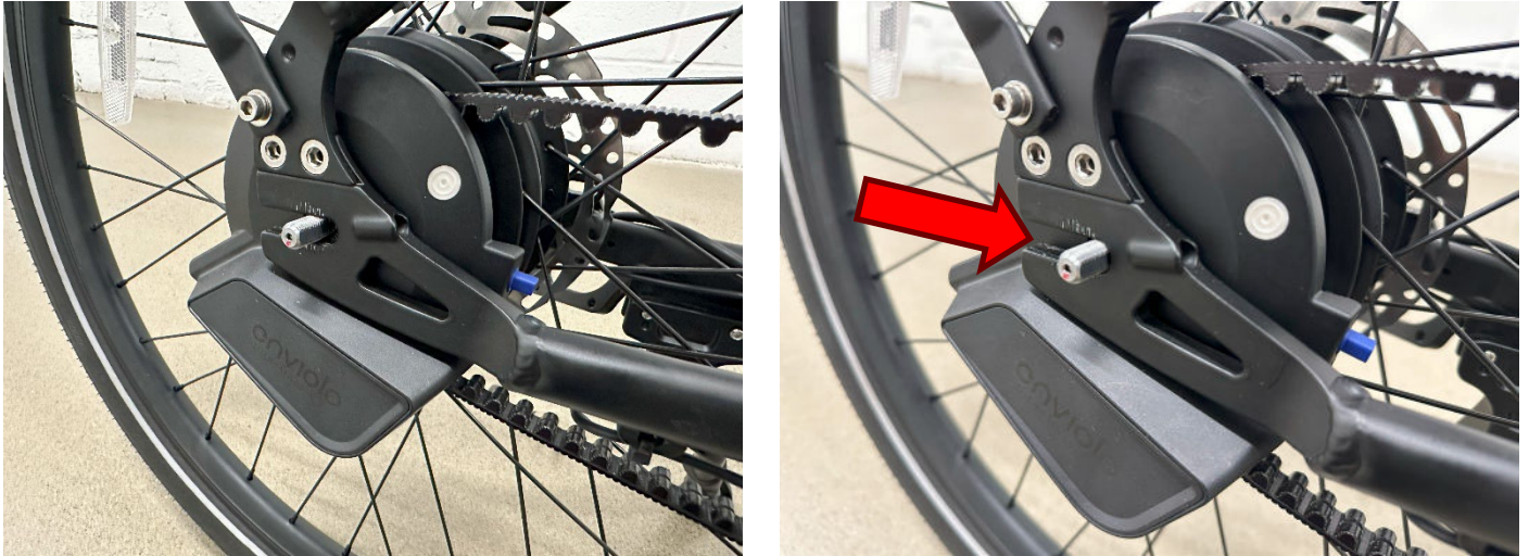
Figure 7 - Pousser la roue arrière vers l'avant du vélo
